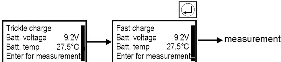
При питании от сети индицируется напряжение аккумулятора и его температура. Индикатор показывает заряд аккумулятора.
