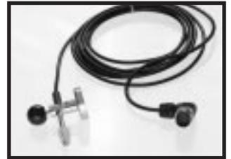
Датчик температуры воздуха длиной 65 мм с резиновым конусом, магнитным креплением и кабелем длиной 3 м
