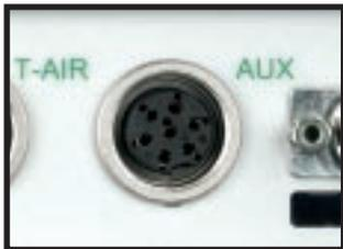
**8** Через вход AUX можно по выбору подключать датчики, например датчик давления, температуры, расхода, влажности и т.д.
