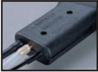
**3** Непрерывное измерение тяги с одновременной индикацией на дисплее освобождает от необходимости переключения шлангов прибора.
