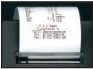
**1** Выразительная и свободно программируемая распечатка содержит все данные измерений, а также вводимые вручную и сохраненные сажевое число и имя и адрес клиента, при необходимости сервисной распечатки для простоты диагностики ошибок, например неисправности O<sub>2</sub>-сенсора.
