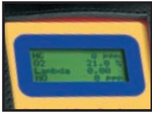
2 Auf dem gut lesbaren, beleuchteten Display werden bis zu 4 Messwerte angezeigt.
