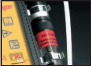
3 Kondensatfalle und Mikrofilter.
